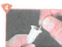
Ziehen Sie die Deckelfolie vom Röhrchen mit dem Verdünnungsmittel ab und setzen Sie das Röhrchen in die vorgeformte Einbuchtung auf der Schachtel ein.
